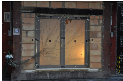
Fig. 1: più di 8 milioni di cicli e ancora come nuovi: chiusura tagliafuoco con vetri Pilkington Pyrostop ® proveniente dall'aeroporto di Monaco, anno di costruzione 1989, durante il test antincendio presso l'ift di Rosenheim.
