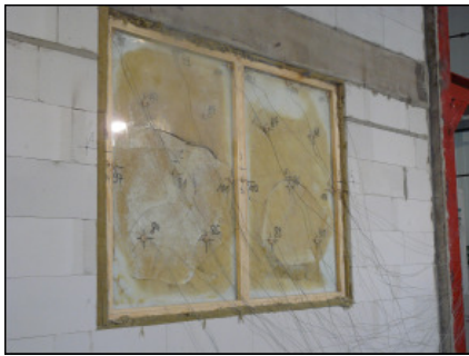
Fig. 3: test antincendio eseguito presso il laboratorio di verifica della DMT a Lathen, su vetri Pilkington Pyrostop ® installati per 33 anni. Il tempo di resistenza minimo è stato agevolmente superato, addirittura i vetri dopo 48 minuti rispettavano ancora il criterio dell'integrità.
