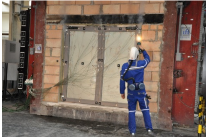
Fig. 2: la porta con vetri Pilkington Pyrostop ® , installata da più di 24 anni, ha soddisfatto pienamente gli attuali requisiti previsti riguardo all'integrità e all'isolamento. Il tempo di resistenza minimo di 30 minuti è stato agevolmente superato: a 36:30 minuti si è interrotto il test.
