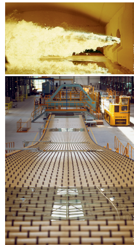
Intérieur du four et ligne de float ; Dans le cadre de l'initiative renew:glass, Pilkington a pour objectif d'augmenter la quantité de verre float recyclé de manière responsable et de lui donner une nouvelle vie
