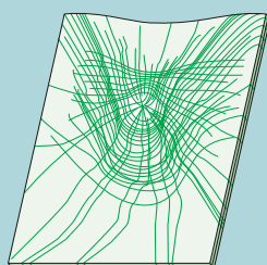
I laminerat säkerhetsglas häftar glassplittret fast vid plastfolien och minimerar risken för skärskador.
