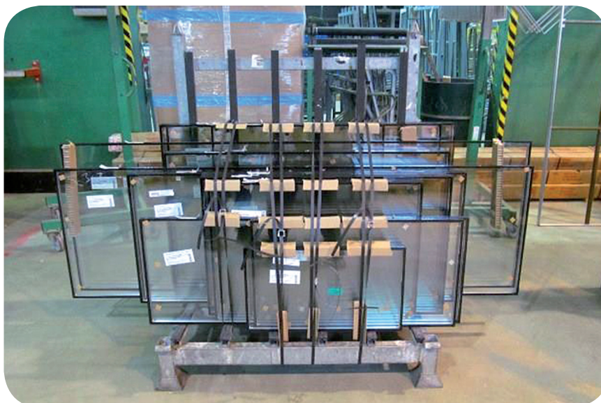
Rysunek 30. Przykłady sposobów pakowania i zabezpieczania szyb na stojakach.
