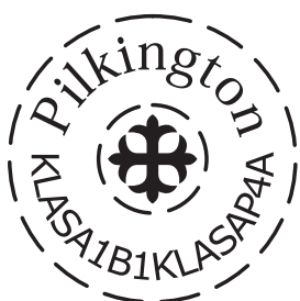
Rysunek 4. Przykład oznakowania szyby laminowanej w klasie P4A.
