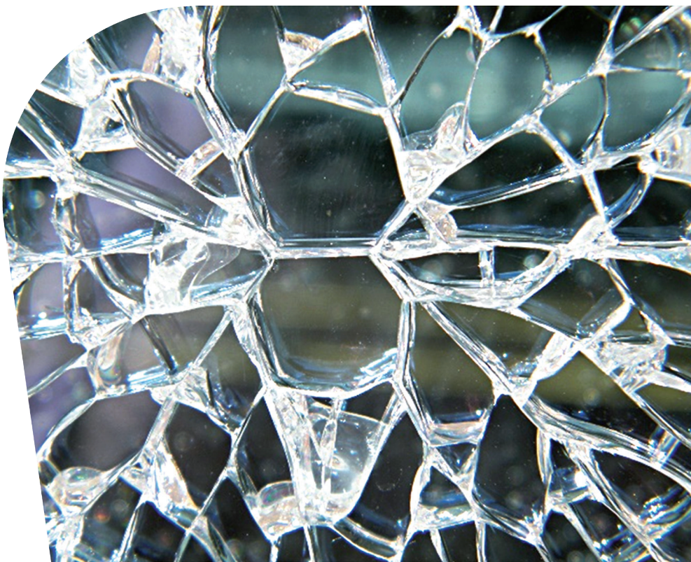
Rysunek 10. Widok siatki spękań szyby hartowanej, w której mogło dojść do samoistnego pęknięcia z powodu inkluzji NiS.
