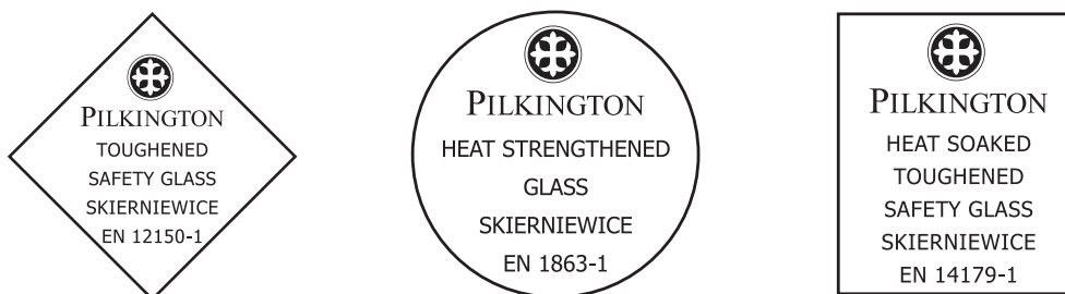
Rysunek 3. Przykłady trwałego oznakowania formatek szkła hartowanego, szkła wzmacnianego termicznie oraz szkła hartowanego wygrzewanego termicznie.
