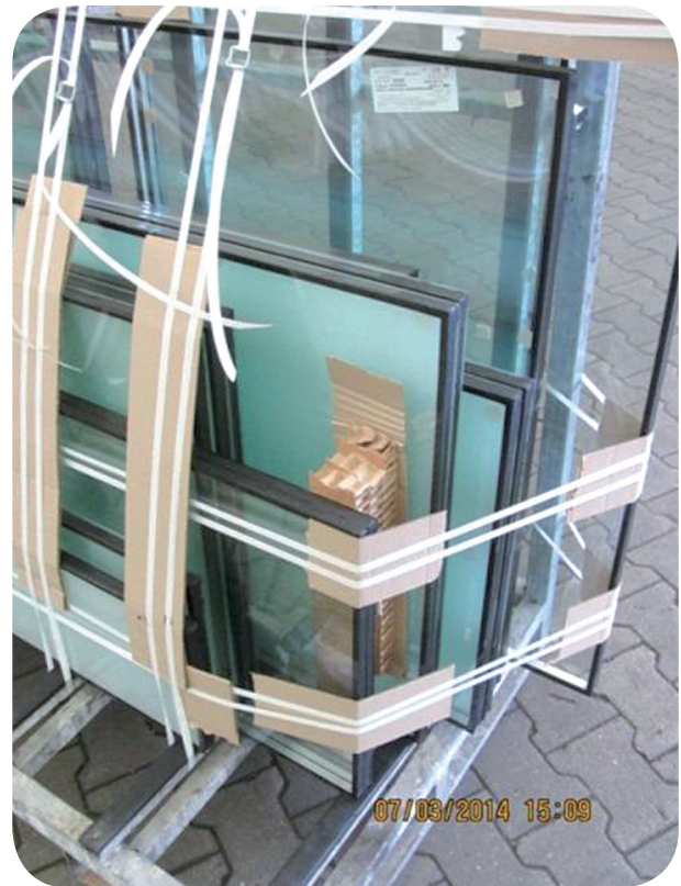
Rysunek 31. Przykłady sposobów pakowania i zabezpieczania szyb na stojakach.
