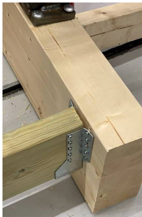
Figur 30 Defomasjon av beslag og uttrekk av skruer
