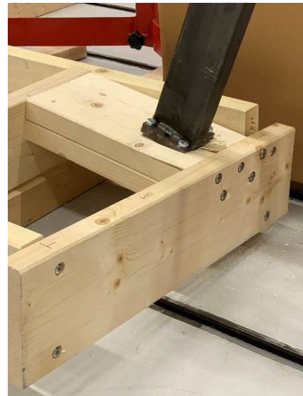
Figur 66 Test 42, ved bruddlast på 3,3 kN
