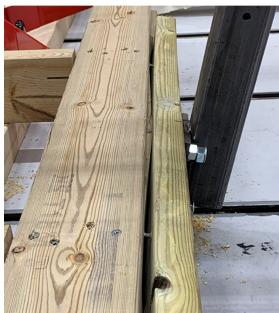
Figur 35 Topplanke sprekker ved bruddlast.
