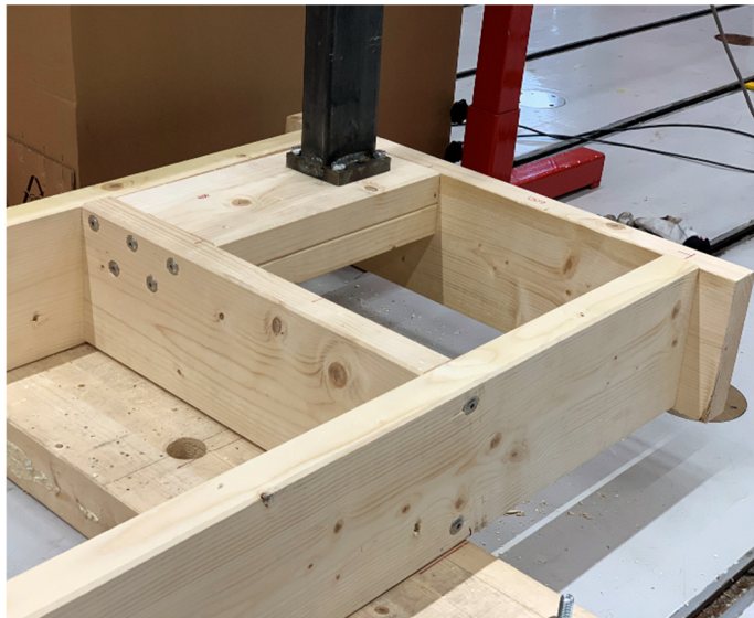
Figur 65 Prøveoppstilling S, test 42. Konstruksjonen består av 48 mm x 198 mm konstruksjonsvirke og er i hovedsak skrudd sammen av 8x120 mm treskruer med stort hode.
