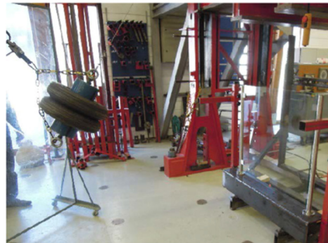
Fig. 5. Pendelprøving av Metode C .
