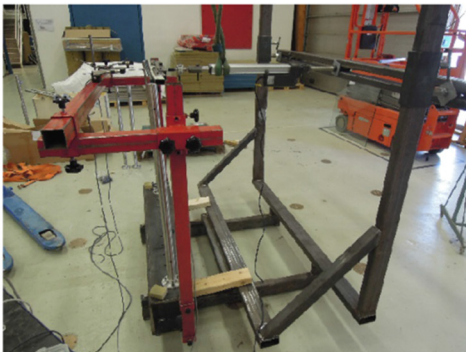
Fig. 2. Rekkverksprøverigg med aktuator og lastpåføringsbjelke ved prøving av Metode B .
