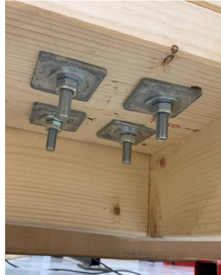
Figur 64 Test 42, med blant annet gjennomgående skruer og store firkantskiver
