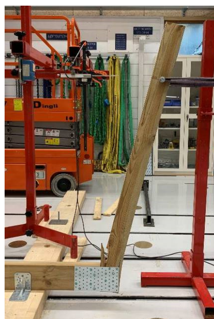
Figur 62 Test 40 ved bruddlast
