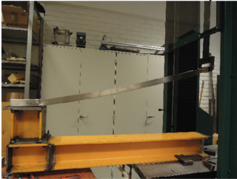
Fig. 1. Rekkverksjigg og universalprøvemaskin ved prøving av Metode A .
