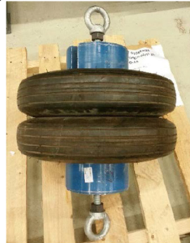
Fig. 4. Pendel til pendelprøving av Metode C .
