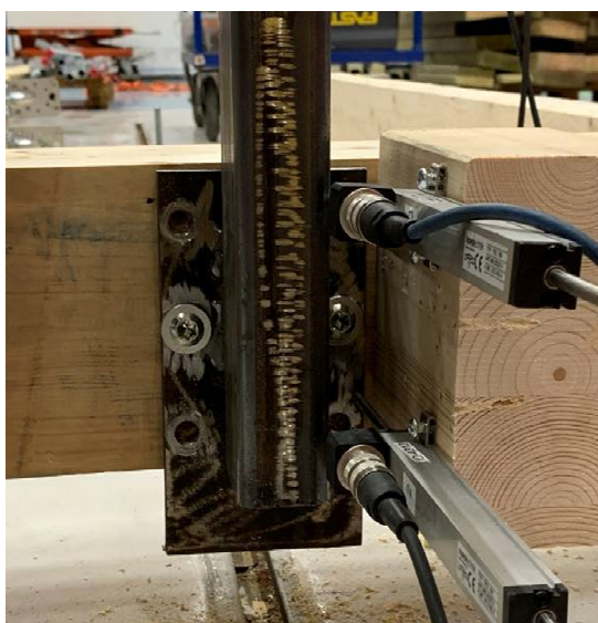
Figur 52 Prøveoppstilling M. Stolpe festet med bare to skruer i midten av fotplaten
