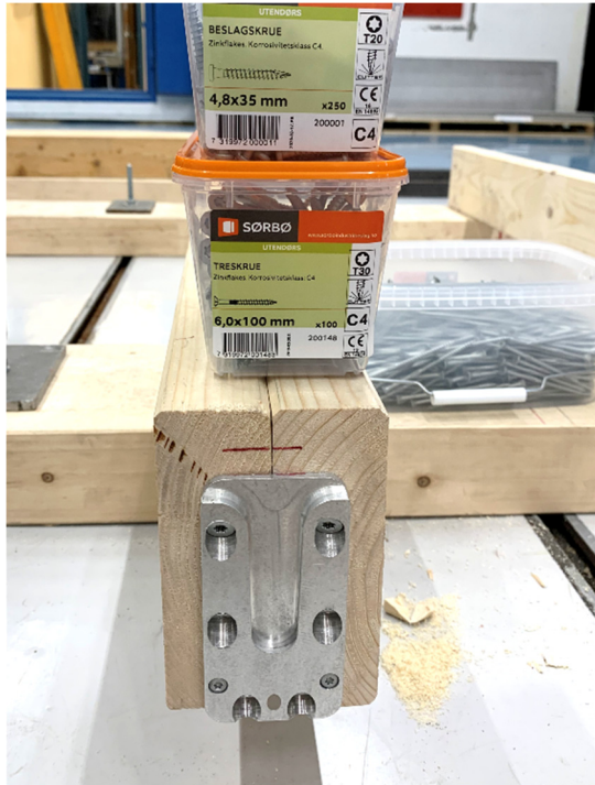
Figur 57 Prøveoppstilling Q. Beslagsdel montert i endevend
