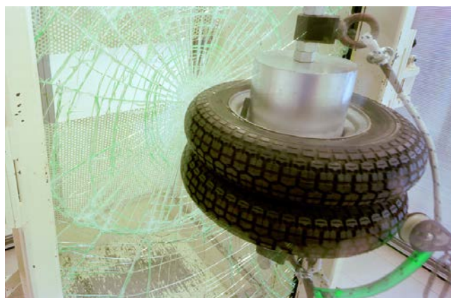
Provino intelaiato rotto:particolare
