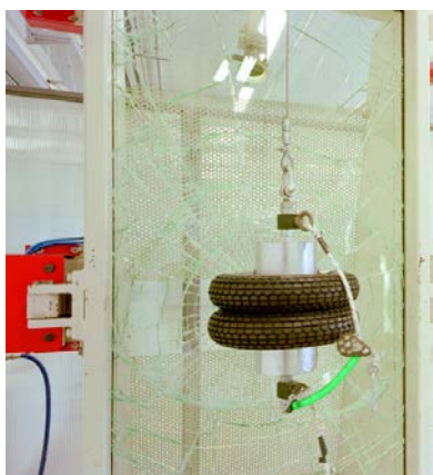
Provino intelaiato rotto
