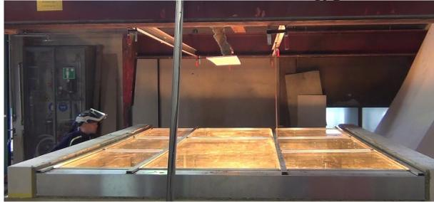
Pilkington **Pyroclear**<sup>®</sup> Plus lors de l'essai au feu dans le laboratoire agréé IBS Linz : le nouveau vitrage de protection incendie pour verrières E/EW 30 a satisfait aux exigences avec une inclinaison de 0° (horizontale). Les dimensions maximales admissibles du vitrage de 1 200 mm x 2 800 mm sont actuellement l'une des plus grandes tailles disponibles sur le marché en matière de verres de protection incendie pour toiture.
