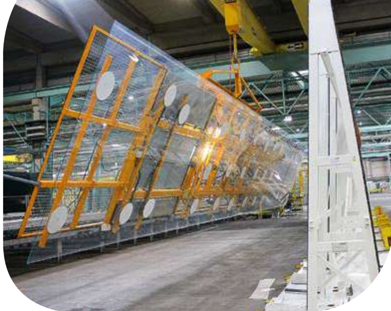
Weiherhammerin tehtaalla Saksassa voidaan valmistaa jopa 20 metriä pitkiä Pilkington Optiwhite™ levyjä.
