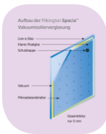
Aufbau der Vakuumisolierverglasung.
