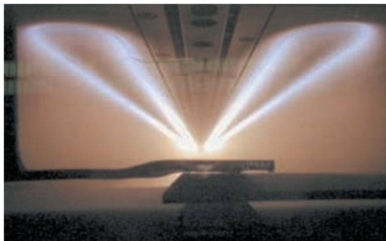
Ensemble de cathodes doubles utilisé pour le dépôt de couche off-line
