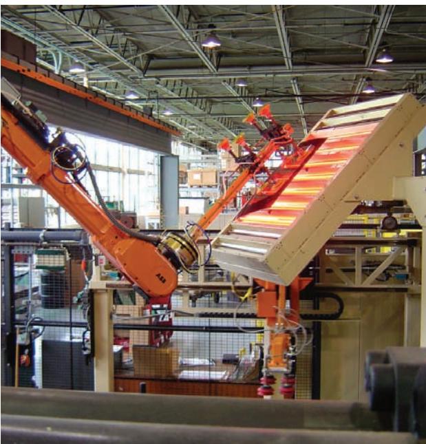
Ein Roboter belädt eine thermoplastische Umspritzungsstation.
